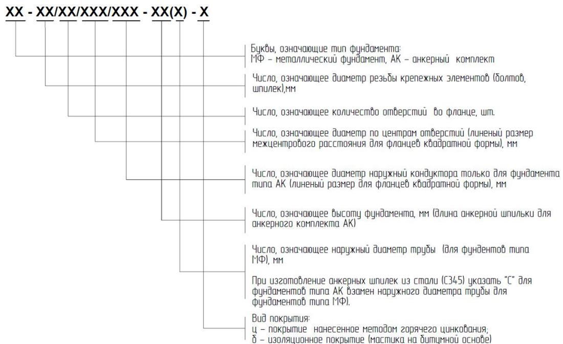
**Примечание:** При использовании фланца металлического элемента фундамента квадратной формы в обозначении ввести дополнительно букву – «к».
